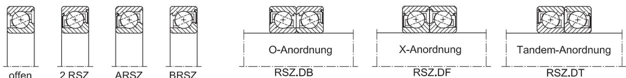
Offene, abgedichtete 40°-Schräggugellager, einzeln u. satzweise
